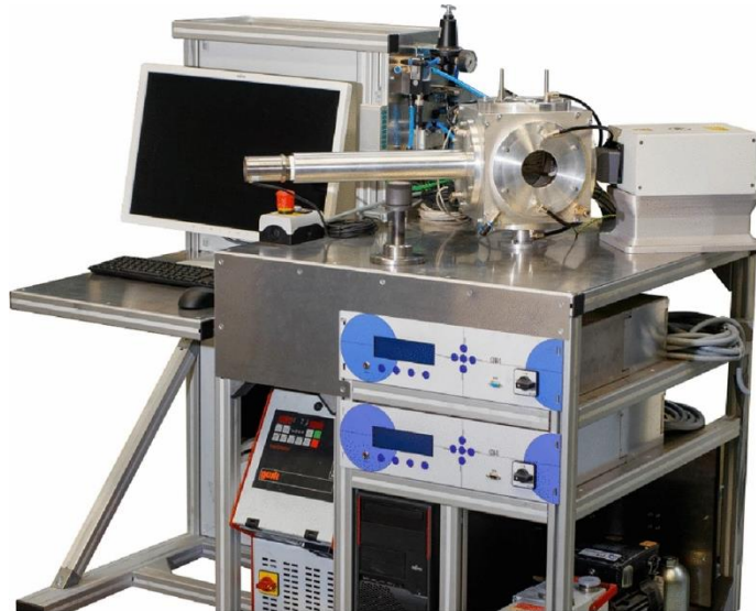
Abbildung 1: Am Lehrstuhl entwickelter Prüfstand für die Wärmebehandlung.
