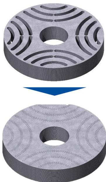
Abbildung 1: Ersetzen der Aussparungen zur magnetischen Flussführung (oben) durch lokale Prägungen (unten)
