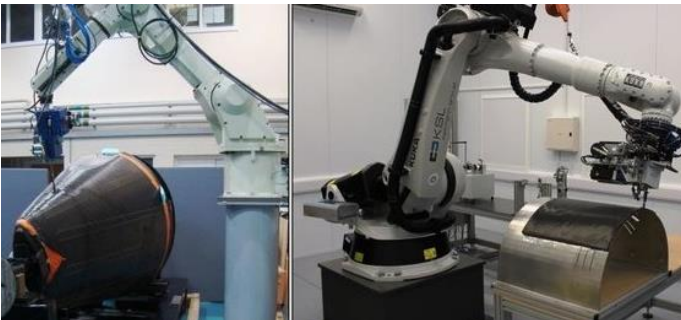
Abbildung: Tufting von CF Komponenten mit komplexen Geometrien für Luft- und Raumfahrtanwendungen [Dell'Anno et al. 2015]
