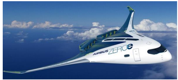
Abbildung: Konzept für ein Flugzeug mit Wasserstoffantrieb für bis zu 200 Passagiere des Luftfahrtkonzerns Airbus. [Airbus]
