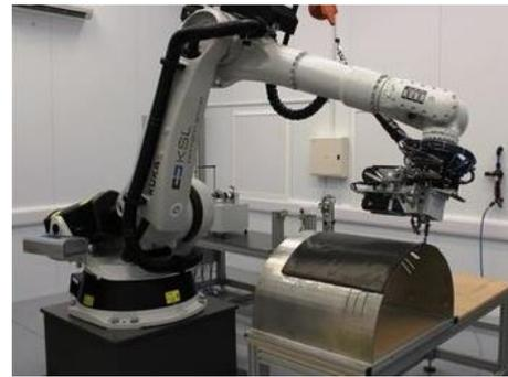
Abbildung 2: Tuften von CF-Komponenten mit komplexen Geometrien für Luft- und Raumfahrtanwendungen [Dell'Anno et al.].
