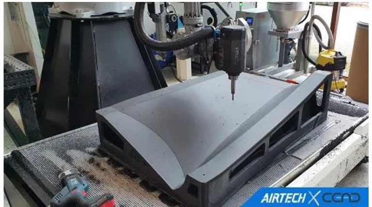
Additiv gefertigtes Formwerkzeug (Quelle: CEAD, Airtech)
