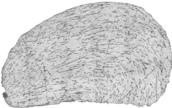
Abbildung 1: Kurzfaserverstärktes Granulat unter dem Mikroskop [Postacchini, 2022]
