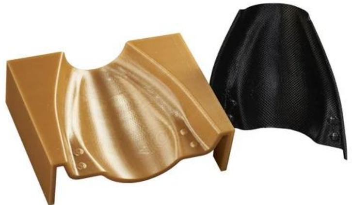
Abbildung: 3D-gedrucktes Laminier-Werkzeug (Stratasys)
