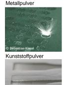
Die Integration von Kamerasystem erlaubt es, alle Schichten während des Bauprozesses einzeln aufzuzeichnen. Aus diesen Daten wird ein digitales Abbild (digitaler Zwilling) des Prozesses erzeugt. Durch die Analyse dieses digitalen Zwillings werden zukünftig Bauteilfehler detektiert und lokale Veränderung Bauteileigenschaften identifiziert. Schadhafte Komponenten könnten damit kostenintensiven ohne zeitund bereits Bauteilprüfungen ausgesondert werden.
