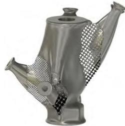
Abbildung 1 Entwurf des formoptimierten und steifigkeitsoptimierten Stahlknotens mit einer integrierten Gitterstruktur
