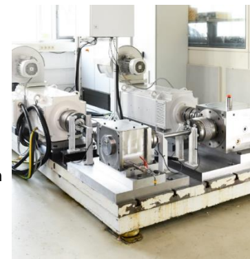
Abbildung 2 Hypoideffizienz-Prüfstand H5E am Lehrstuhl für Maschinenelemente.
