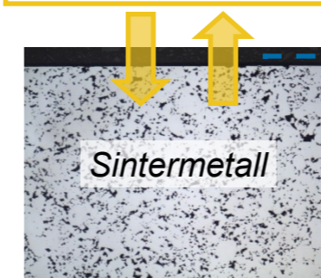
Schmierstoffein- und -austritt über poröse Sintermetalloberfläche durch Beanspruchung
