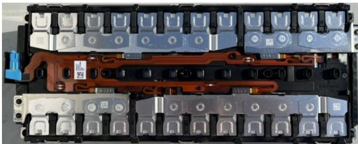
In dieser Arbeit liegt der Fokus auf der Analyse von galvanischen Korrosionseffekten, die bei der Kontaktierung von Batteriezellen auftreten können. In einer geeigneten Versuchsreihe sollen verschiedene, industriennahe Materialpaarungen in unterschiedlichen Verschaltungstopologien untersucht und bewertet
