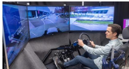
*Uncertainty Quantification und Teleoperation eines automatisierten Fahrzeugs am Lehrstuhl für Fahrzeugtechnik*
