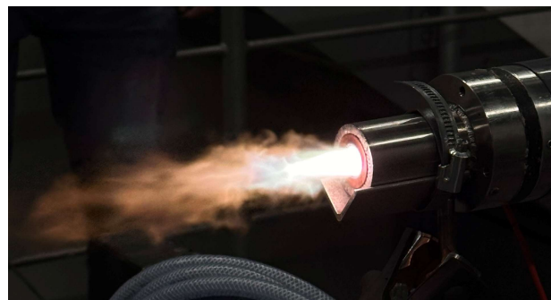
15 kW Luftplasmabrenner am Lehrstuhl für Energiesysteme
