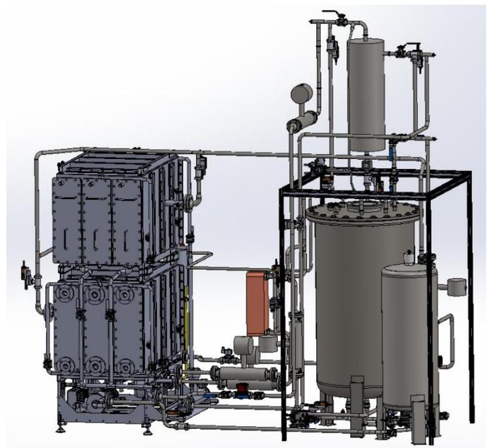
**CAD-Modell des Prototyps des partiell kristallisierenden Absorptionskältespeichers**
