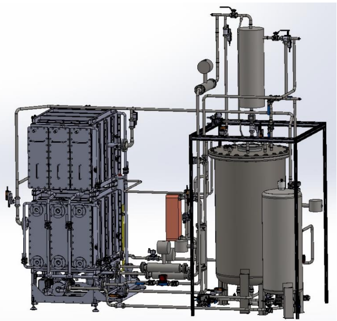
CAD-Modell des Prototyps des partiell kristallisierenden Absorptionskältespeichers
