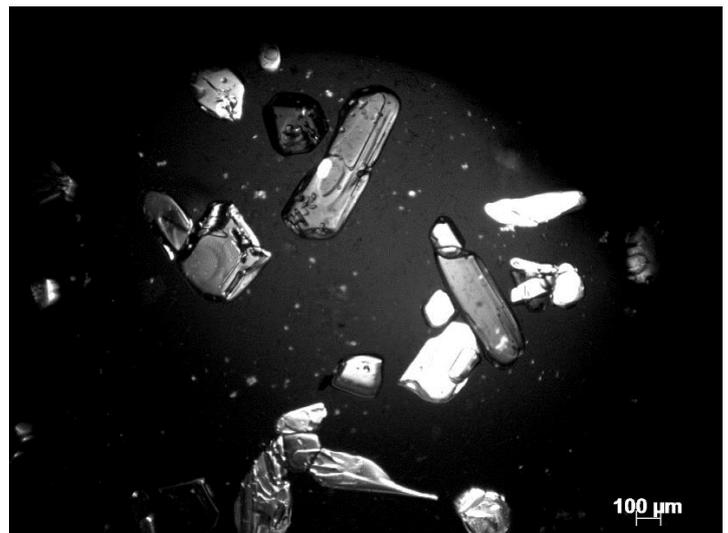
**Mikroskopaufnahme von teilweise kristallisierter Lithiumbromidlösung**
