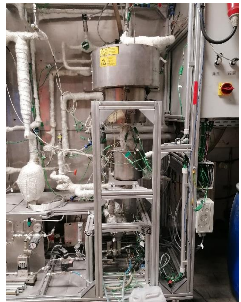
Abbildung: Laborreaktor FiBESToR für Untersuchungen in einer Wirbelschicht und einem Festbett
