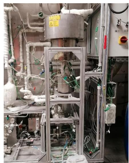
**Abbildung:** Laborreaktor FiBESToR für Untersuchungen in einer Wirbelschicht und einem Festbett
