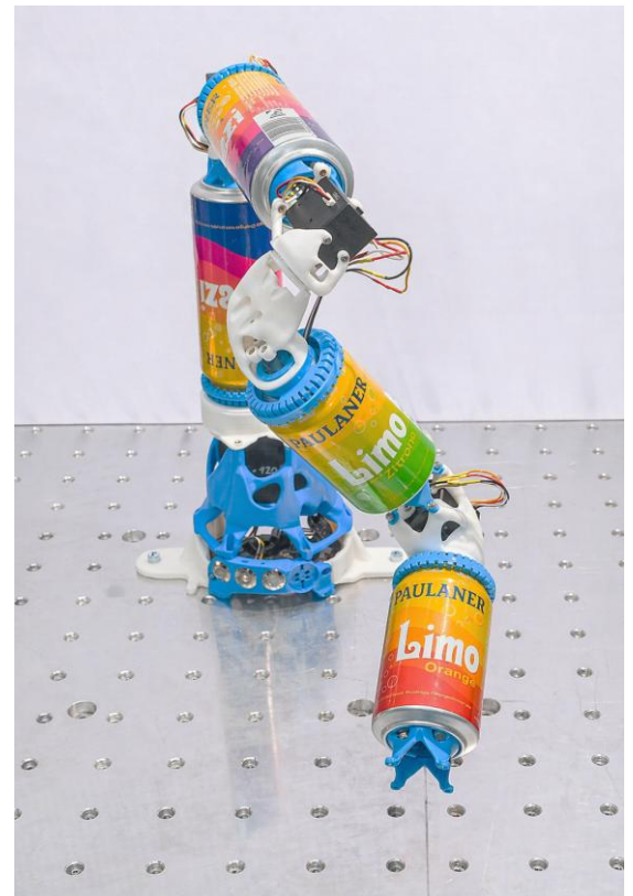
Yes We Can! Beispiel für einen leichten, kostengünstigen und zirkulären Roboter
