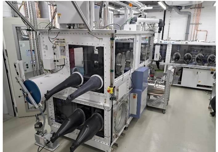
Pilot-Produktionslinie für Festkörperbatterien am iwb
