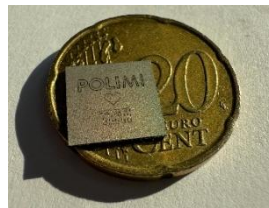
Zuschnitt und Feinmarkierung von Silizium mittels ultrakurzen Laserpulsen
