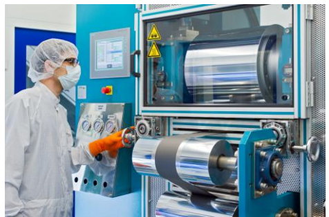
Abbildung der Kalandrieranlage am iwb .
