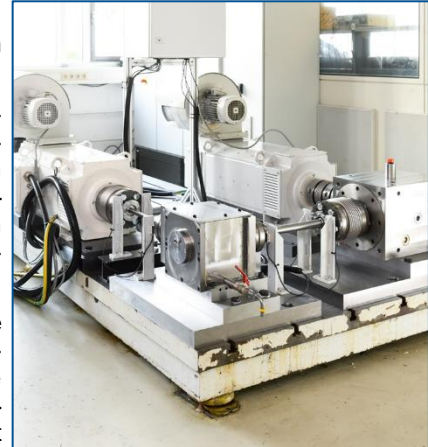
Abbildung 1 Kegelrad- und Hypoidprüfstand H5E am Lehrstuhl für Maschinenelemente
