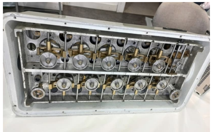
Abbildung 2: Teile des Innenaufbaus des zu untersuchenden Gezeitenrechners. Bildrechte: Deutsches Museum.
