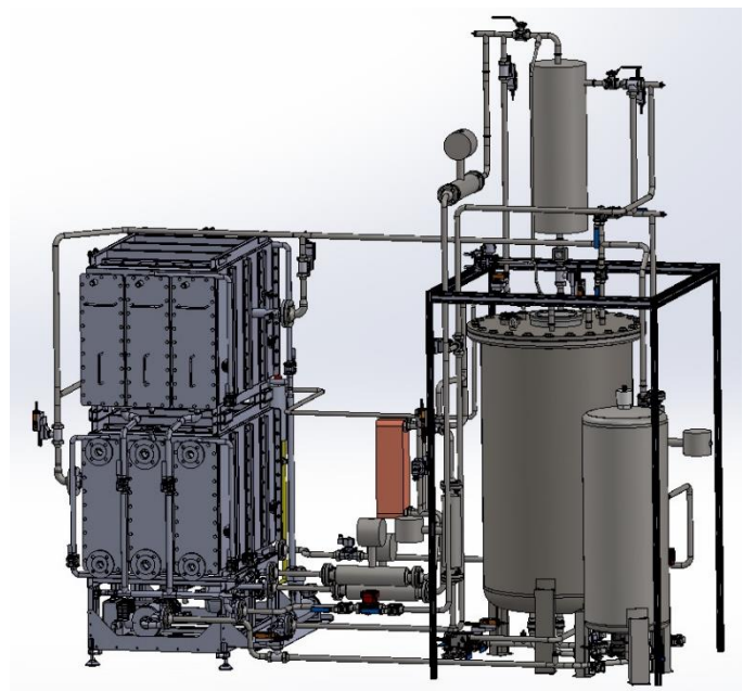
CAD-Modell des Prototyps des Absorptionskältespeichers
